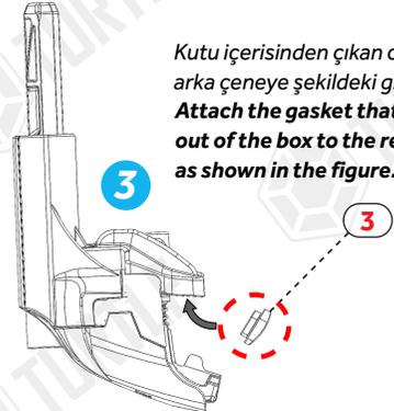
Kutu içerisinden çıkan contayı arka çeneye şekildeki gibi takınız. Attach the gasket that comes out of the box to the rear chin as shown in the figure.
